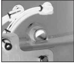
Fan Drain Connection
