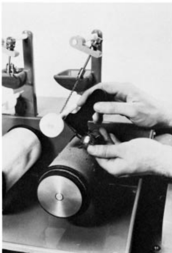
FIG. 6 Adjusting Mace on ICI Snag Tester
