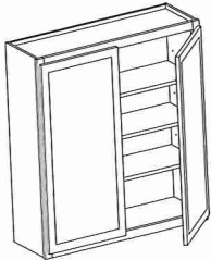
Double Door 42" Height 24", 27", 30", 33", 36", *39" or *42" Width
